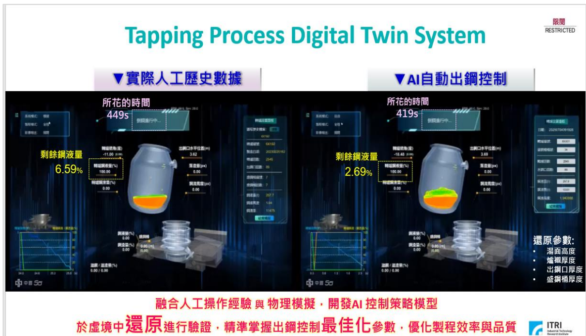
圖 3 轉爐出鋼製程數位雙生系統
